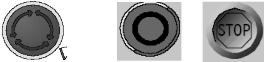
El cual el primero es de “parada de emergencia” el cual el robot para su motor el segundo es el de accionamiento desconectado el cual frena en forma brusca los movimientos que esta realizando el robot y el tercero es el de stop el cual frena los movimientos en forma segura.
