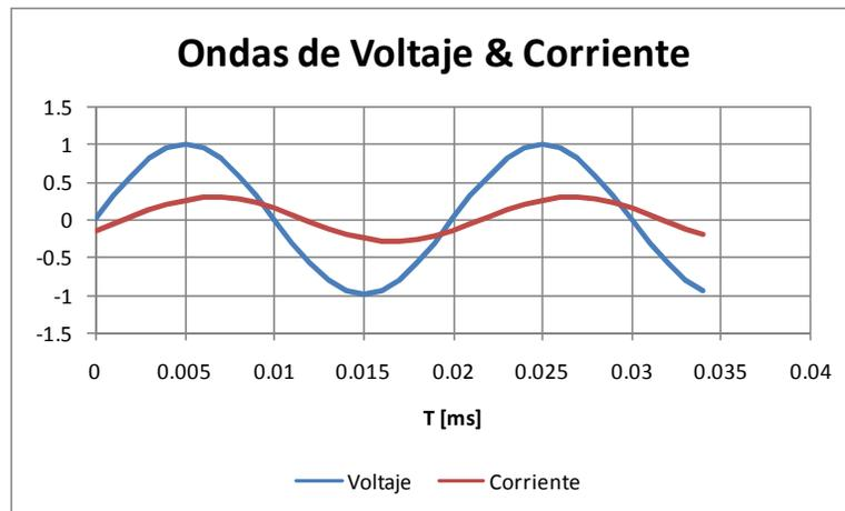
Las ondas sinusoidales tienen la ventaja que se pueden transformar a fasores mediante la función Fasorial F.
