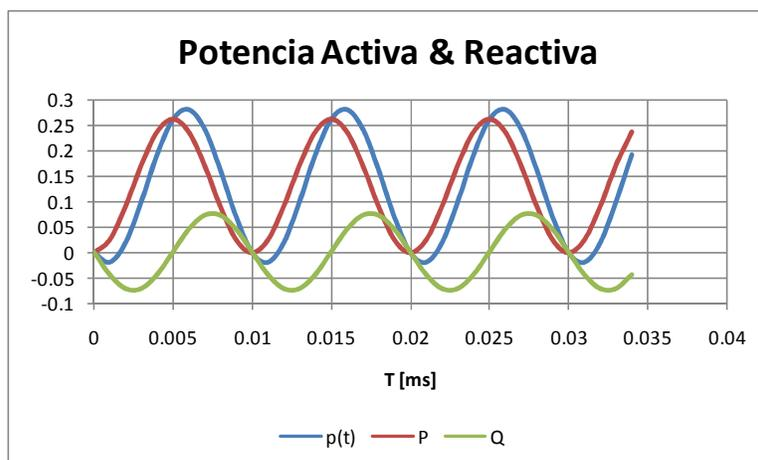
La potencia instantánea se puede descomponer en dos partes. Una onda sinusoidal de frecuencia doble que oscila en torno a la Potencia Activa **P**, y una segunda componente de magnitud igual a la Potencia Reactiva **Q** que oscila en torno a cero. Esto significa que la potencia reactiva tiene promedio cero, y por lo tanto no realiza trabajo.
