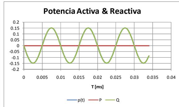
Un condensador está compuesto por dos placas conductoras unidas por un material dieléctrico de tal manera de crear un campo eléctrico entre ambas placas conductoras. La característica sinusoidal de la corriente y la tensión hace que este campo eléctrico varíe en el tiempo con el doble de la frecuencia de la onda de corriente. En otras palabras el condensador carga y descarga 2 veces la energía del campo eléctrico en él por cada periodo de la onda de tensión.
