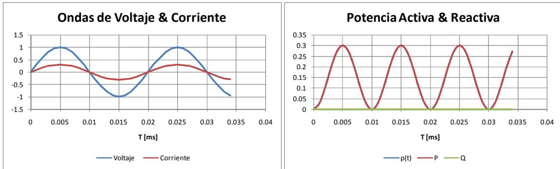
De los resultados anteriores se puede observar que una carga puramente resistiva, no provocara un desfase entre las ondas tensión y corriente, por lo tanto el desfase tendrá un valor  $\psi = 0^\circ$ . Entonces una carga resistiva solo consume potencia activa y no reactiva.
