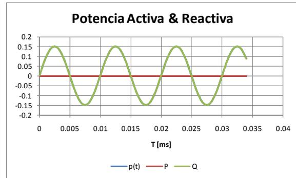
Una inductancia, es una bobina que acumula energía en su núcleo generando un campo Magnético el cual se cargara y descargara 2 veces dentro del ciclo de las ondas tensión y corriente. En otras palabras la inductancia no realizo trabajo.
