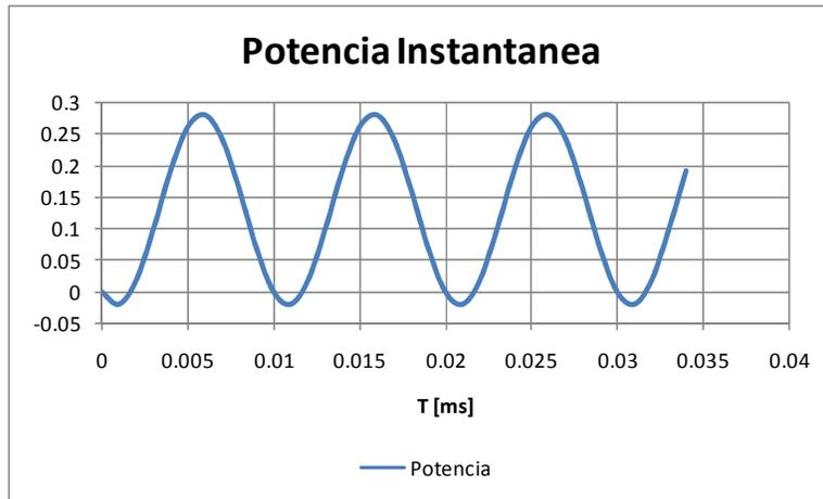
De la expresión anterior se puede observar que la potencia instantánea es una señal sinusoidal de frecuencia doble a la de la tensión aplicada, y que oscila en torno a un valor promedio de  $P = V_{\max} I_{\max} \cos(\psi) / 2$ .
