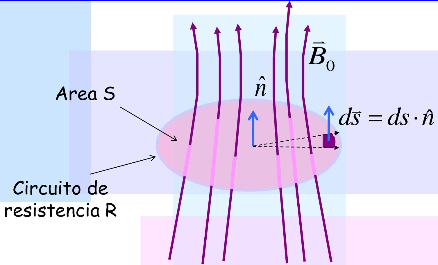
Flujo del campo magnético a través del circuito  $\phi = \iint_S \vec{B}_0 \cdot d\vec{s}$
