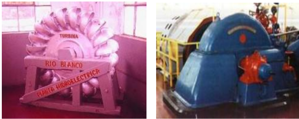
Figura 5.8: a) Rodete y cuchara de una turbina Pelton; b) Turbina Pelton y alternador
