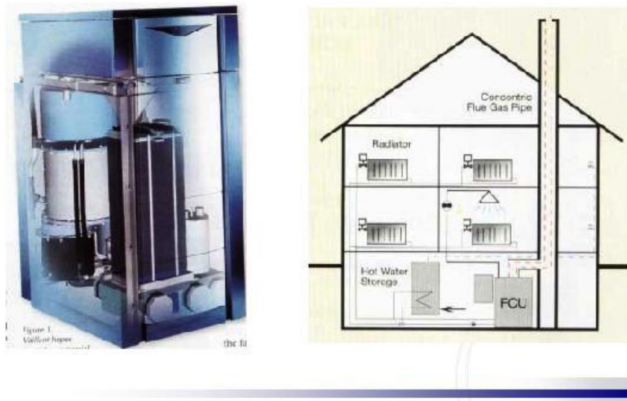
Figura 5.13: Aplicación de las CC para generación eléctrica hogareña.
