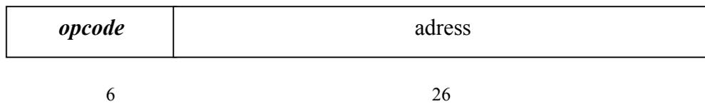
**Figura Im.11:** Formato de Instrucción de salto incondicional (*J-format*)
