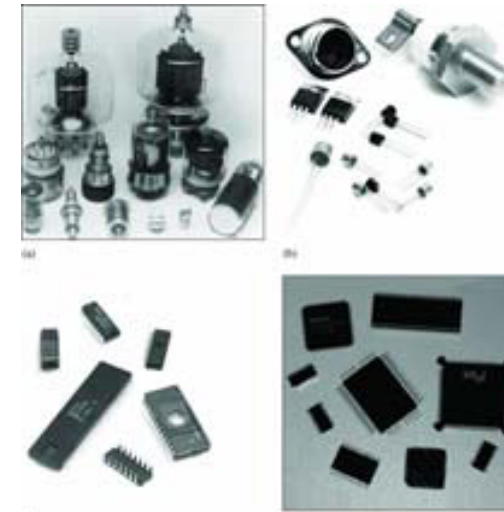
Arriba-Iz: Tubos de vacío, Arriba-Der: Transistores discretos, Abajo-Iz: Circuitos integrados de pequeña (SSI) y mediana escala (MSI) y Abajo-Der: Circuitos integrados de gran escala (VLSI).
