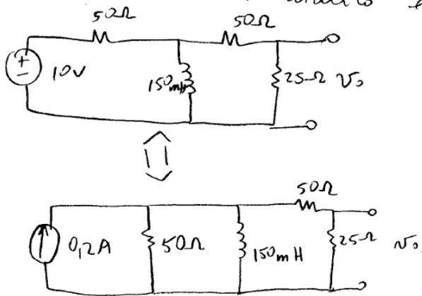
La inductancia se ha cargado después de un largo tiempo y la corriente se mantiene fija (estado estacionario) y por lo tanto  $v_L = 0$ . Como la inductancia se comporta como un cc. absorbe todo la corriente de la fuente y  $i_L(t=0) = 0,2A$ .
