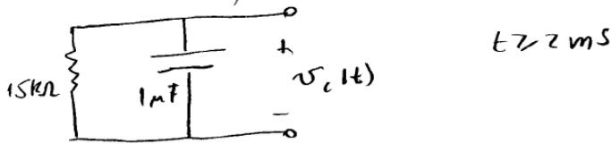
La respuesta está dada entonces por los parámetros del circuito y la condición inicial  $V_c(t=2\text{ms}) = 6,88\text{V}$
