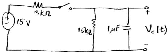
Para  $t < 0$ , la respuesta natural del circuito es descargar el condensador a través de la resistencia de  $15\text{k}\Omega$ .
