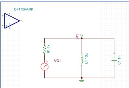
Figura 6: Circuito RLC paralelo con una fuente de voltaje
