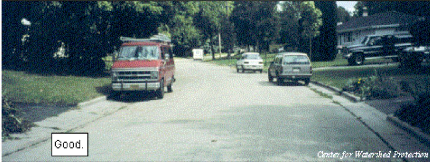
**Las calles anchas crean cubierta impermeable innecesaria, aumentan velocidades del tráfico y deterioran seguridad peatonal**
