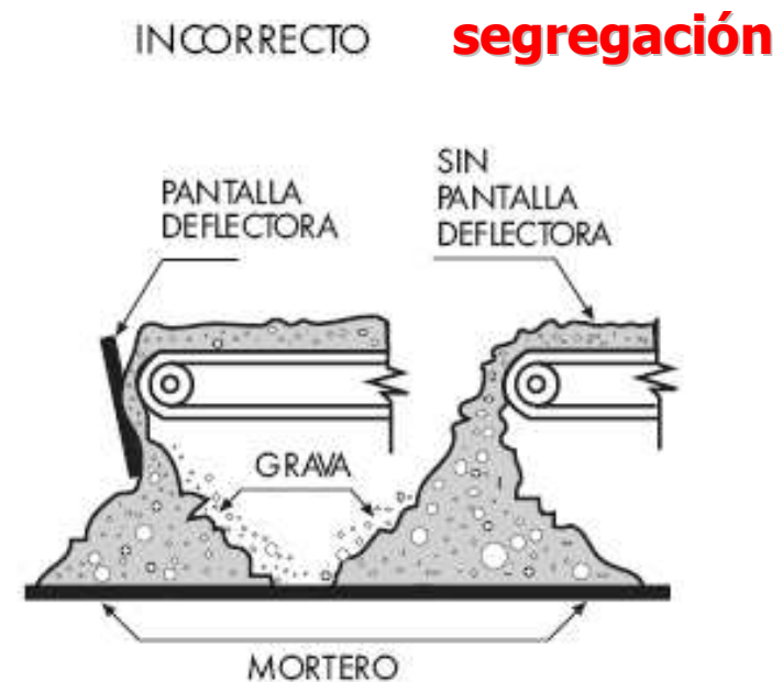
FIG. 9: Control inadecuado en el extremo. En general una pantalla deflectora sólo cambia la dirección de la segregación.
