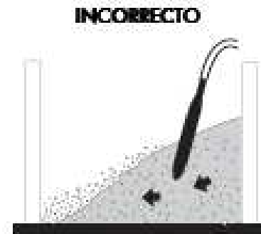
FIG. 34: El vibrador no se debe usar para transportar y distribuir el hormigón (no debe arrastrarse dentro de él), esto causa segregaciones. Tampoco se debe permitir su funcionamiento fuera del hormigón por un periodo prolongado de tiempo.
