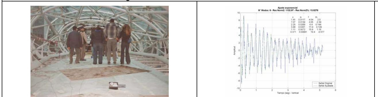
Figura 6.7 Impacto por salto en pasarela peatonal. Respuesta y ajuste a varias frecuencias mediante técnicas de optimización.
