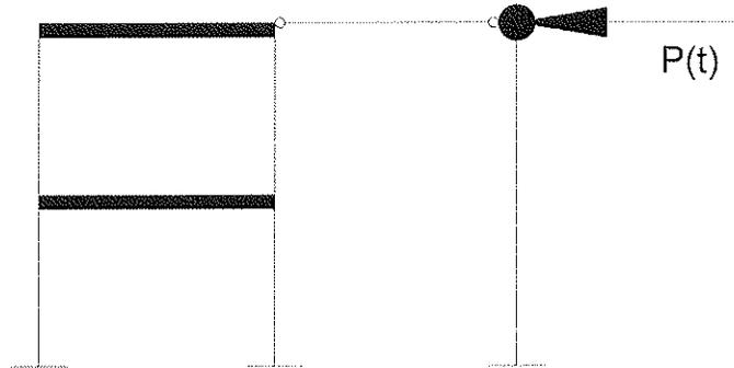
La carga está definida como media senoide, de amplitud máxima  $P_0$  y duración  $t_0$ . Se pide determinar el desplazamiento absoluto máximo del nivel intermedio de la estructura izquierda.
