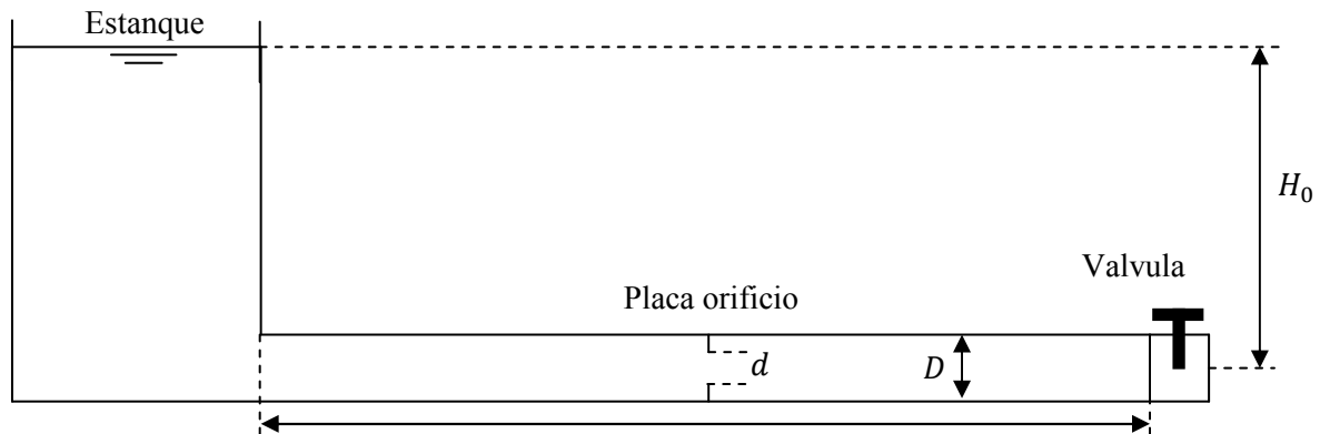
Figura: Sistema de estanque, tubería y válvula.
