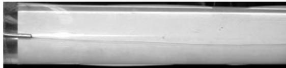
Al aumentar la velocidad, el flujo muestra fluctuaciones que destruyen el comportamiento ordenado del flujo laminar: **TRANSICIÓN LAMINAR - TURBULENTO**
