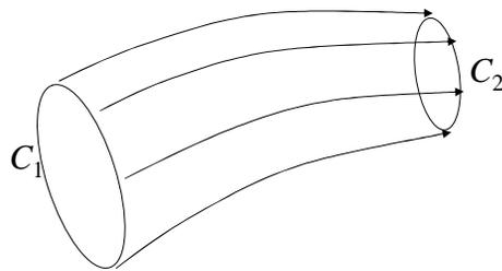
Un vector velocidad no puede salir perpendicular a la superficie definida por el manto del tubo de flujo.
