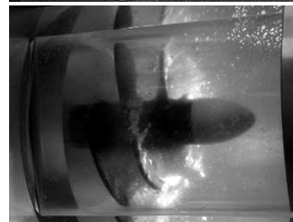
Generación de burbujas de vapor de agua en el extremo de los álabes. Debido a la gran velocidad, la presión disminuye y alcanza el valor de p_v .
