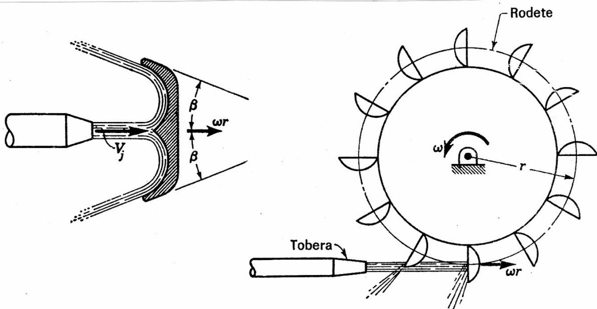
El chorro se divide en dos partes iguales sobre la cuchara. Si se desprecian la gravedad y el roce, el agua no cambia su velocidad con relación a la cuchara, mientras dura su acción.
