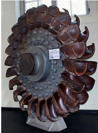
El rodete (cucharas y rueda) tiene un radio  $r$ , medido en el centro de las cucharas. Es cargado por un generador eléctrico, y gira a una velocidad angular constante,  $\omega$ , radianes/segundo, en sentido antihorario. La tobera entrega un caudal  $Q$ ,  $\text{m}^3/\text{s}$ , con una velocidad  $V_j$  medida respecto a ejes estacionarios.
