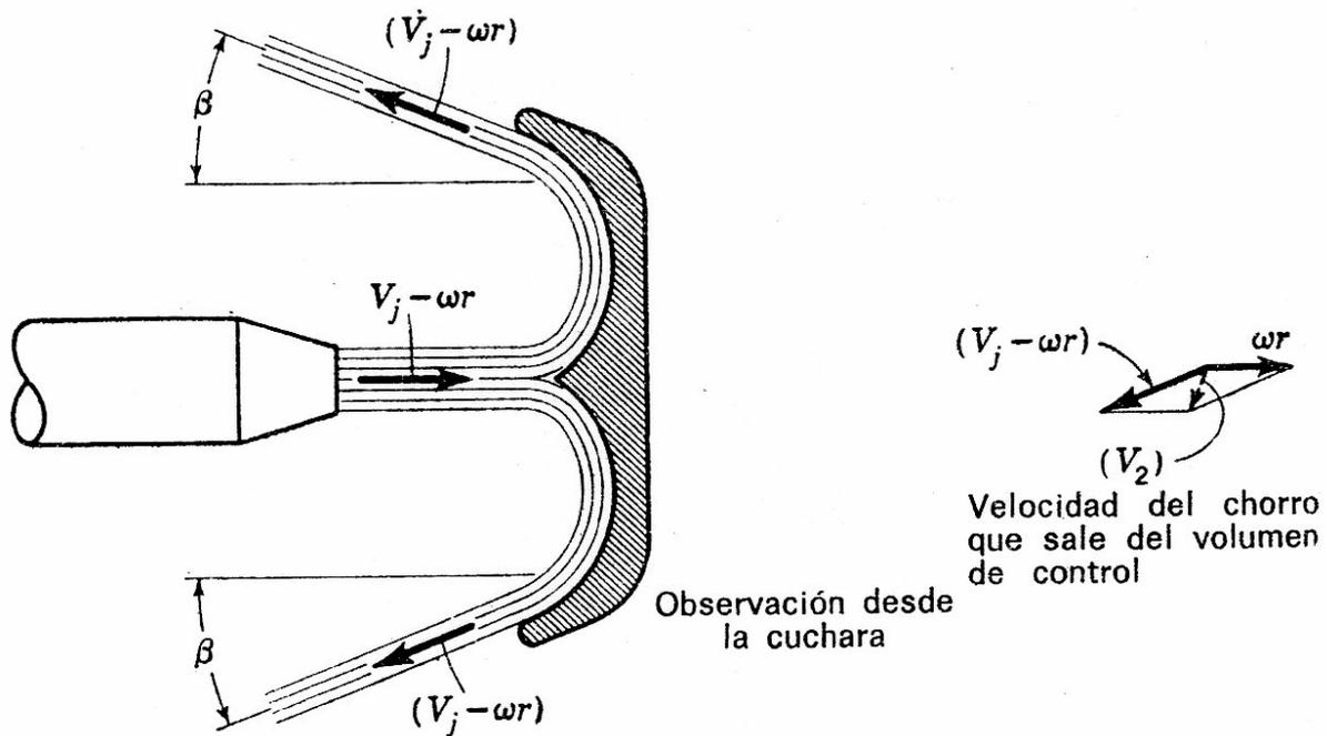
Con respecto a la cuchara el chorro se mueve con una velocidad  $V_j - \omega r$ . Las salidas tienen una velocidad de igual módulo, pero con un ángulo de inclinación  $\beta$  impuesto por la forma de la cuchara. Entonces, respecto a ejes estacionarios, la componente de velocidad horizontal de los chorros de salida es:
