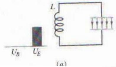
La energía eléctrica almacenada en el circuito LC, en un instante cualquier  $t$ , de acuerdo con las ecuaciones (2 de la carga) y de la energía  $U_E = \frac{q^2}{2C}$  es:
