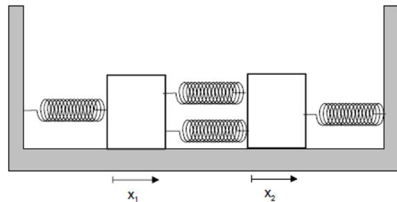
**P2.** Hay dos bloques de la misma masa  $M$  y cuatro resortes iguales de constante elástica  $k$  cuya posición de equilibrio estable con los resortes en su longitud natural es la que se muestra en la figura. Para oscilaciones pequeñas descritas mediante  $x_1$  y  $x_2$ . Determine las frecuencias propias de oscilación y las coordenadas normales. No hay roce.
