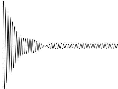
Figura 5.17: La función  $x(t)$  de un oscilador de frecuencia natural  $\omega_0$ , amortiguado y forzado por una fuerza periódica con frecuencia  $\omega$  (la forzante) muestra un comportamiento inicial transitorio donde las dos frecuencias compiten, pudiendo haber batido en esta etapa. A tiempos largos el comportamiento es oscilatorio simple con la frecuencia  $\omega$  de la forzante como se desprende de (5.5.9).
