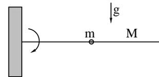
Si el sistema se libera desde el reposo con la barra en posición horizontal, se observa que el anillo comienza a deslizar cuando la barra forma un ángulo  $\pi/4$  con la horizontal. Determine (a) el momento de inercia del sistema antes que el anillo comience a deslizar, (b) la velocidad angular y aceleración angular de la barra en el instante en que el anillo va a comenzar a deslizar, (c) la fuerza que ejerce sobre la barra el punto de apoyo.
