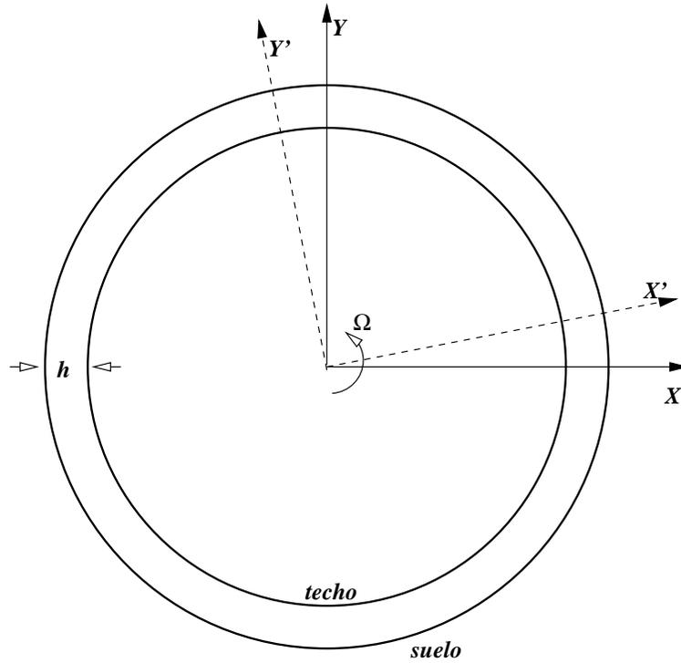
Figura 7.6: Nave espacial en la forma de un gran anillo que rota. El radio desde el centro al suelo es  $r_0$  y hay un “techo” a altura  $h$  del suelo, como lo muestra la figura. La nave gira con velocidad angular  $\Omega$  perpendicular al plano de la figura. Los ejes  $(X', Y')$  están fijos a la nave.
