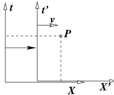
Figura 9.1: Si dos sistemas de referencia inerciales con ejes cartesianos paralelos se mueven con velocidad relativa  $v$  en la dirección de los ejes  $X$  y  $X'$ , la relatividad de Galileo establece que las coordenadas espaciotemporales en  $S$  y  $S'$  de un evento  $P$  se relacionan según:  $x' = x - vt$ ,  $y' = y$ ,  $z' = z$ ,  $t' = t$ .
