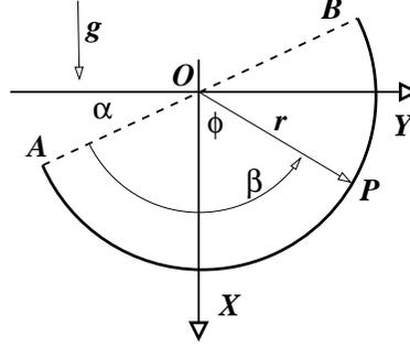
Figura 2.10: Un alambre semicircular de radio  $R$  y masa total  $M$  oscila como péndulo en torno al punto  $O$ . Un punto arbitrario  $P$  del arco se puede definir con respecto al ángulo  $\phi$  con el eje fijo  $X$  o bien con el ángulo  $\beta = \frac{\pi}{2} + \phi - \alpha$  que subtende el arco  $AP$ . Para  $P$  fijo en el arco, el ángulo  $\beta$  es una constante y el movimiento pendular implica  $\dot{\phi} = \dot{\alpha}$ .
