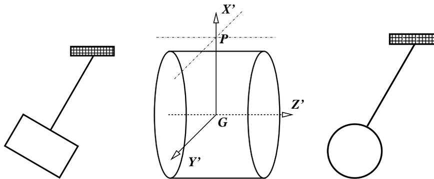
Figura 8.15: Se considera también un cilindro cuyo eje es horizontal y un punto  $P$  que está a distancia  $L$  sobre  $G$ . Se estudia el caso en que el eje de rotación es paralelo al eje  $Y'$  (perpendicular al eje del cilindro y caricaturizado en el dibujo izquierdo) y el caso en que el eje de rotación sea paralelo al eje del cilindro y caricaturizado en la figura de la derecha. En ambos casos el vector que va de  $P$  a  $G$  es  $\vec{R} = -L\hat{i}'$ .
