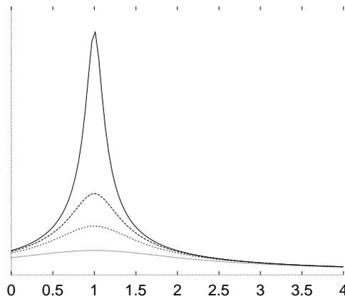
Figura 5.16: La amplitud  $A(\omega)$ , dada en (5.5.6), de un oscilador de frecuencia natural  $\omega_0$ , amortiguado y forzado por una fuerza periódica con frecuencia  $\omega$  (la forzante) muestra para diversos valores del parámetro de amortiguación  $q$  un máximo (resonancia) en  $\omega = \omega_r$  (definido en (5.5.7)). Mientras menor el amortiguamiento mayor es la amplitud  $A$ .
