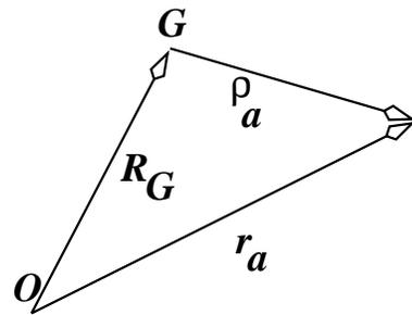
Figura 2.8: El vector posición  $\vec{r}_k$  de una partícula  $k$  se puede descomponer en la suma del vector posición del centro de masa,  $\vec{R}_G$ , y el vector posición de  $k$  desde el centro de masa,  $\vec{\rho}_k$ .
