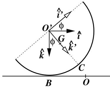
Figura 8.10: Un alambre semicircular se mantiene en un plano vertical oscilando de tal modo que su punto central  $C$  se levanta (como en esta figura), desciende, haciendo contacto en  $\mathcal{O}$  y luego levantándose por el otro lado. En la figura el arco tiene contacto con la horizontal en el punto  $B$  y está inclinado en un ángulo  $\phi$  con respecto a su posición de equilibrio estático. En el equilibrio estático  $\phi = 0$ , y  $C$  coincide tanto con  $\mathcal{O}$  como con  $B$ .
