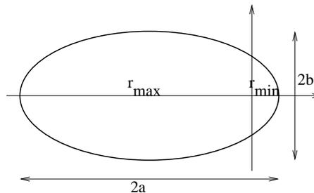
En la forma original descrita en (6.2.7) esta es una elipse con uno de sus focos en el origen y tiene sus radios mínimo y máximo sobre el eje  $X$ . Se tomará el caso  $e > 0$ .
