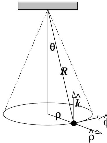
Figura 2.5: Un punto material en el extremo de un hilo de largo  $R$  gira en una trayectoria circular de radio  $\rho$ . El otro extremo del hilo está fijo. Este sistema es un péndulo cónico. *pcónico*
