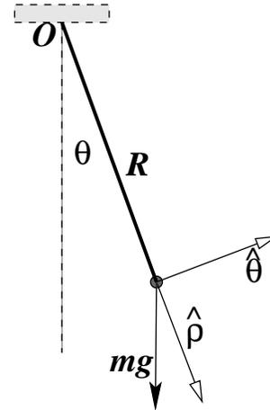
Figura 2.6: Un péndulo consta de un hilo de largo  $R$  fijo en un extremo a un punto  $O$ . En el otro extremo hay una masa puntual  $m$ .
