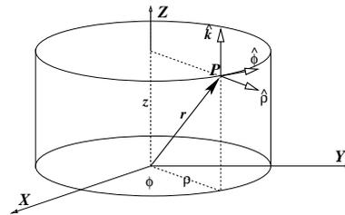
Figura 1.2: Las coordenadas cilíndricas de un punto  $P$  son:  $\rho$ , la distancia de  $P$  al eje  $Z$ ,  $\phi$  que es el ángulo que forma el plano que pasa por el eje  $Z$  y por  $OP$  con el plano  $XY$  y la coordenada  $z$  que es igual que en el caso cartesiano.
