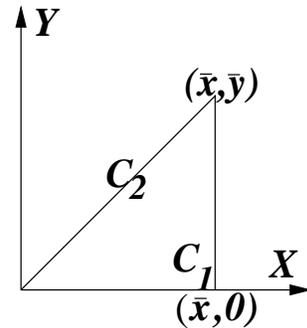
Figura 4.2: En el ejemplo se definen dos caminos,  $C_1$  y  $C_2$  para calcular la integral de trabajo.
