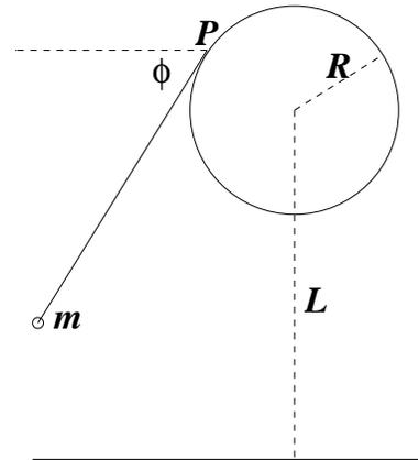
**Indicación:** Conviene tomar el origen en el eje del cilindro y escribir el vector posición del cuerpo como la suma de los vectores posición del punto  $P$  de tangencia del hilo ( $\vec{r}_P$  en la dirección  $\hat{p}$ ) y el vector que apunta en la dirección del hilo y que es tangente al cilindro, en la dirección  $\hat{\phi}$ .
