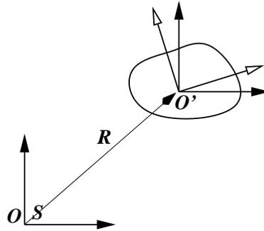
Figura 8.2: Se tiene un sistema inercial  $S$  con origen en  $\mathcal{O}$  y dos sistemas con origen en el punto  $\mathcal{O}'$  fijo al sistema móvil:  $S'$  y  $S''$ . El primero,  $S'$ , tiene ejes que se mueven solidariamente con el sistema extendido y mientras que  $S''$  mantiene sus ejes paralelos a los de  $S$ .
