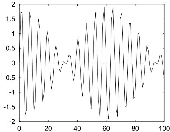
Figura 5.13: Un oscilador de frecuencia natural  $\omega_0$  forzado por una fuerza periódica con frecuencia  $\omega$  cercana a la frecuencia  $\omega_0$  muestra un comportamiento temporal en paquetes como se aprecia en la figura. Si dos cuerdas de guitarra se afinan a notas muy cercanas el sonido que resulta al tocarlas simultáneamente tiene esta propiedad que se llama de batido, claramente audible. Esta es una propiedad de la solución (5.3.6).
