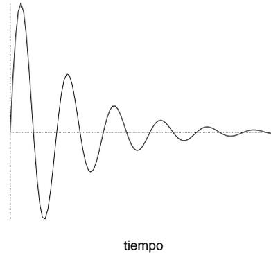
Figura 5.15: Las oscilaciones de un oscilador amortiguado van decreciendo con el tiempo, manteniendo su frecuencia tal como se describe en (5.4.6).
