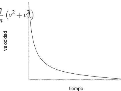
Figura 3.13: Forma como decrece  $v(t)$  en un movimiento ascendente, según (3.4.24) de coeficiente de roce y de una viscosidad cuadrática.
