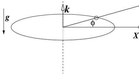
Figura 2.2: Una argolla que puede deslizar libremente, sin roce, a lo largo de una varilla y la varilla gira barriendo con velocidad angular uniforme  $\dot{\phi} = \omega$  un plano horizontal. argolla
