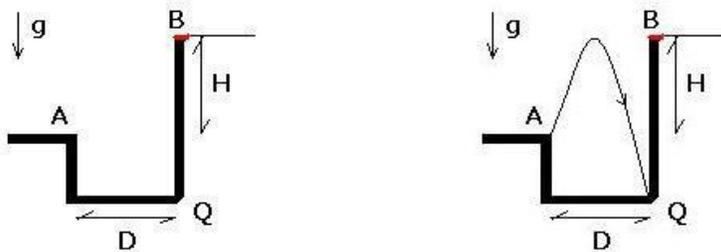
Se pretende lanzar un proyectil desde **A** hasta el borde opuesto **B**. Existe una diferencia de altura **H** y un ancho **D** entre ambos puntos.
