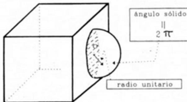
Figura I.3: Al dibujar la esfera con centro en el punto de simetría de las caras, vemos que el ángulo sólido subtendido (área de la esfera) es la mitad de la superficie total de la esfera.
