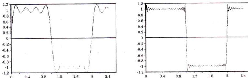
Figura I.19: El gráfico de la izquierda corresponde a la serie truncada en el octavo término. Si se incluyen los primeros 41, se obtiene el gráfico de la derecha.
