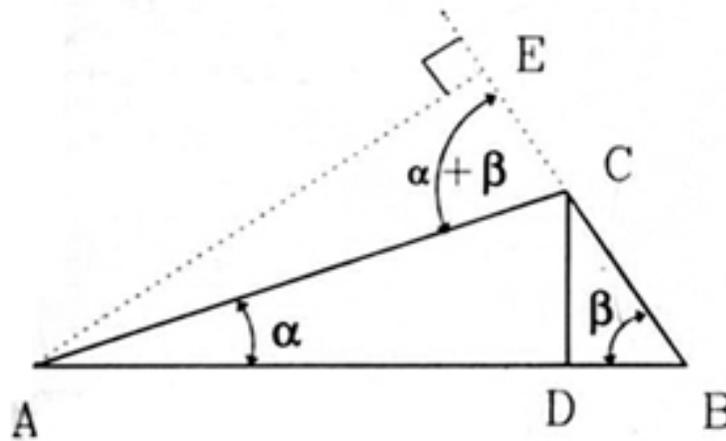
Figura I.6: Triángulo  $\triangle ABC$  usado para encontrar geoméricamente el valor de  $\text{sen}(\alpha + \beta)$  en función de senos y cosenos de los ángulos  $\alpha$  y  $\beta$ .
