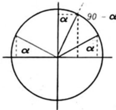
Figura I.5: De la Figura se desprende que  $\text{sen}(180 - \alpha) = \text{sen } \alpha$ , y otras igualdades trigonométricas citadas anteriormente en el texto.
