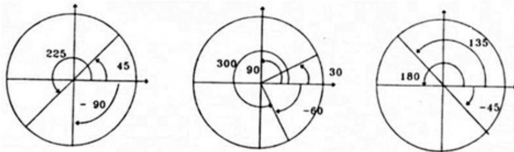
Figura I.1: En la Figura se muestra la medida de diversos ángulos como  $180^\circ$ ,  $90^\circ$ ,  $45^\circ$ , y otros. Se define además, el sentido positivo y negativo de un ángulo.
