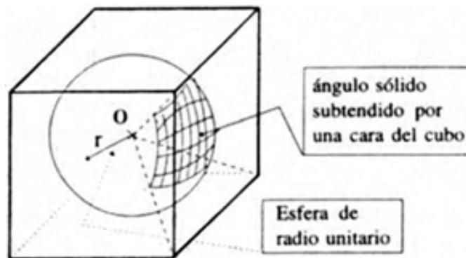
Figura I.2: Ángulo sólido subtendido por una de las caras de un cubo con respecto al centro del mismo. La esfera tiene radio unitario.
