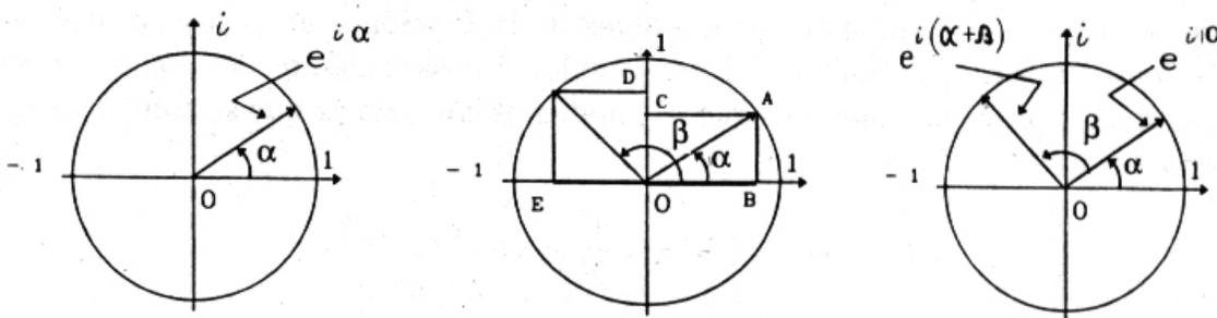
Figura I.7: A la izquierda se muestra el vector  $e^{i\alpha}$ . En el disco de la derecha se grafica  $e^{i(\alpha+\beta)}$ . El sumar un ángulo al vector anterior, sin cambiar su módulo, es equivalente a rotarlo en el ángulo  $\beta$
