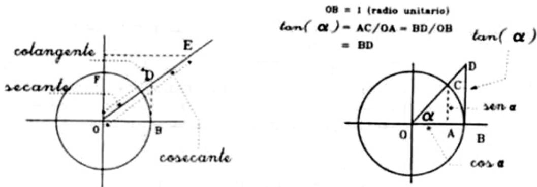
Figura I.8: Resumen de las definiciones geométricas de las funciones: cotangente, cosecante y secante. La circunferencia tiene radio unitario.
