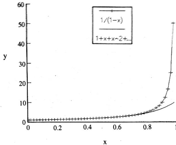
Figura I.10: Comparación entre la función  $1/(1-x)$  (gráficada con +) y la aproximación polinomial, que incluye hasta potencias de orden 10 (línea continua). En la aproximación, se corta la serie infinita, manteniendo sólo los primeros términos.
