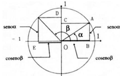
Figura I.4: El valor de  $\text{sen } \alpha$  está dado por la proyección del vector  $OA$  sobre el eje vertical y el valor del coseno es la proyección sobre el eje horizontal. El radio de la circunferencia es la unidad
