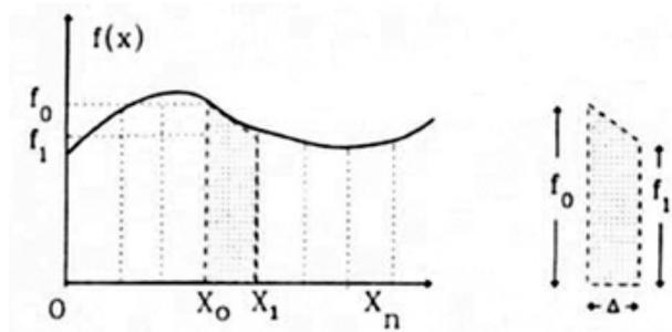
Figura I.15: Regla de Trapecio. Tomando un conjunto de puntos de la curva, se calcula el área como la suma del área de los trapecios construidos uniendo los puntos mediante rectas.
