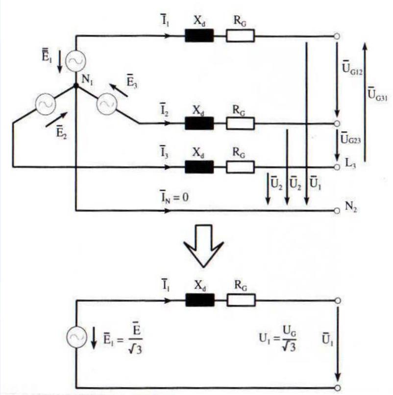
Circuito Equivalente Trifásico y Monofásico
