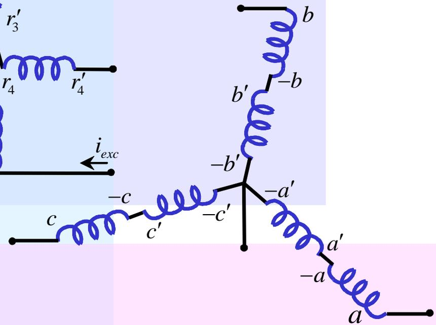
Conexión Serie de Bobinas en Máquina de 2 pares de polos
