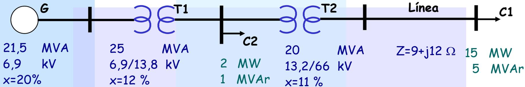
Calcular tensión en bornes del generador, tal que tensión en carga principal sea 95%
