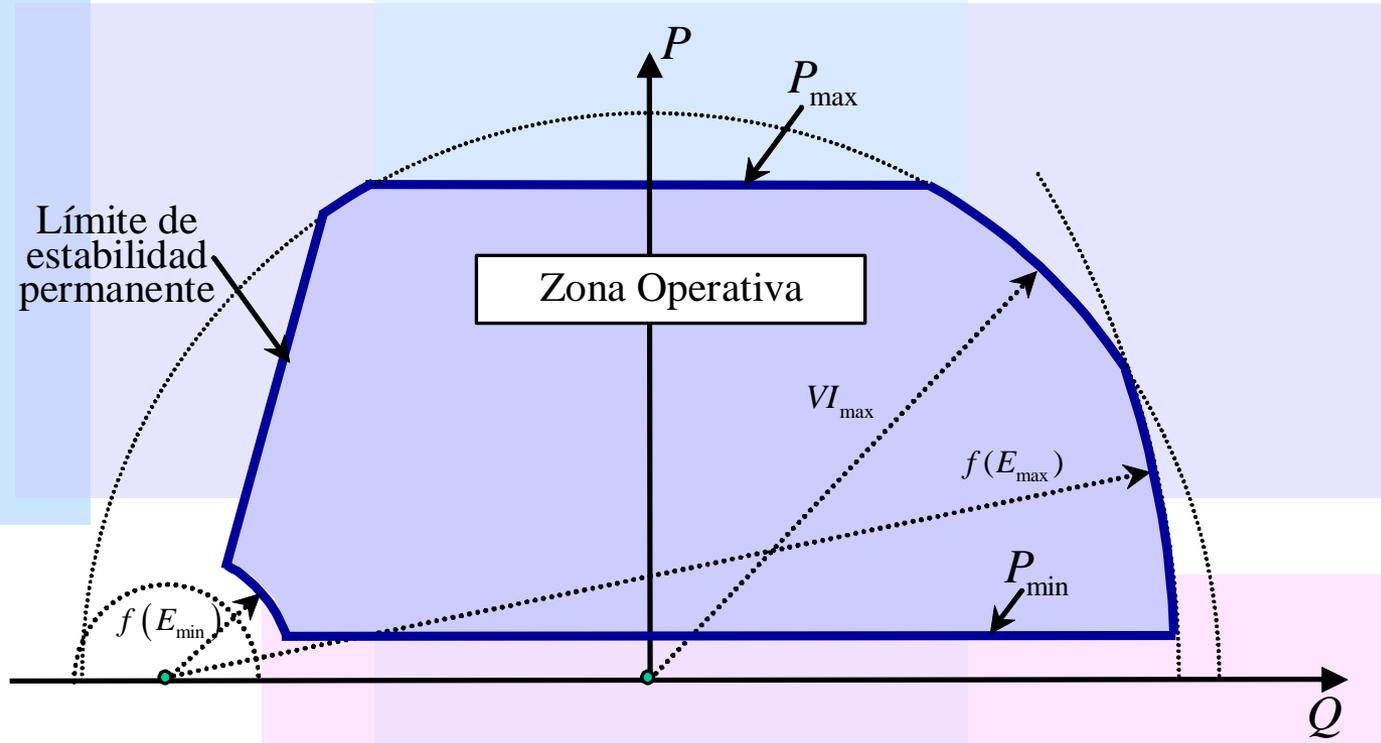
Diagrama de Operación del Generador Sincrónico
