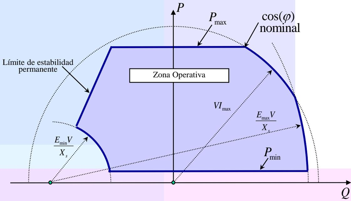
Diagrama de Operación del Generador Síncrono Rotor cilíndrico
