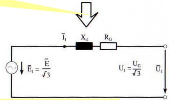
Circ  $X_{\sigma} = (0,07 \dots 0,2) X_h$  básico y Monofásico
