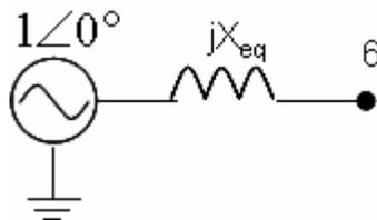
**Ilustración 2: Equivalente del sistema visto desde barra 6**
