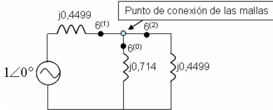
**Ilustración 9: Conexión de las mallas de secuencia**
