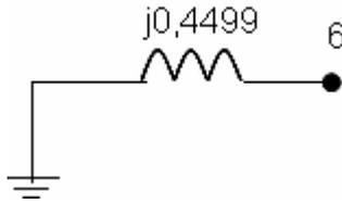
**Ilustración 6: Equivalente de secuencia negativa visto desde barra 6**
