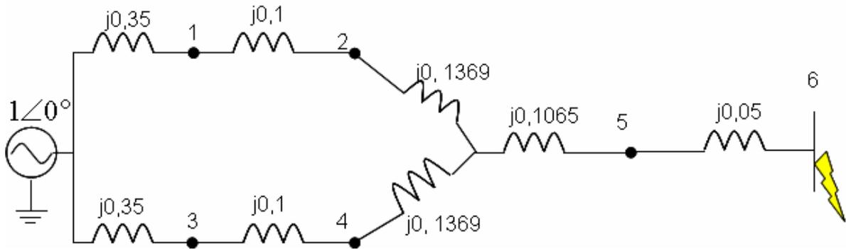
**Ilustración 3: Malla de secuencia positiva con transformación delta-estrella**
