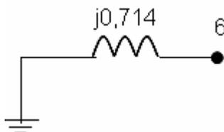
**Ilustración 8: Equivalente de secuencia cero visto desde la barra 6**
