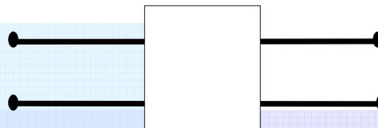
Utilizaremos los tetrapolos lineales pasivos para representar los parámetros fundamentales de elementos de tipo rama.
