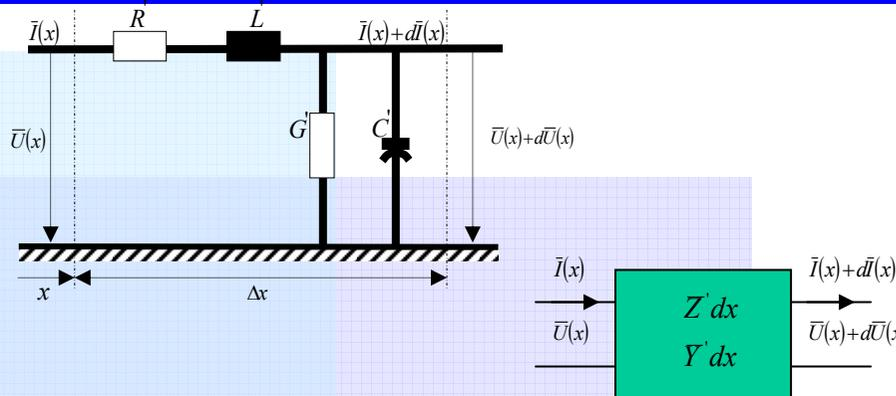
Para los Voltajes y Corrientes se tiene (esquema de tetrapolo elemental de largo  $dx$ ):
