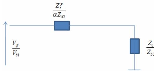
Existen dos zonas, por eso los subíndices 1 y 2. Notemos que la impedancia del transformador está dividida por la impedancia base de la zona 2, ya que el dato de impedancia nos lo dieron referidos al lado de baja. Además, aparece un coeficiente alfa para dar cuenta de alguna posible división (por un tres o una raíz de tres). Tampoco lo sabemos ahora, pero lo dejamos ahí para determinarlo al final.
