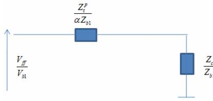
Existen dos zonas, por eso los subíndices 1 y 2. Notemos que la impedancia del transformador está dividida por la impedancia base de la zona 1, ya que el dato de impedancia nos lo dieron referidos al lado de alta. Además, aparece un coeficiente alfa para dar cuenta de alguna posible división (por un tres o una raíz de tres). Por ahora no lo sabemos, pero lo dejamos ahí para determinarlo al final.
