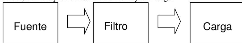
La impedancia interna de la fuente senoidal es de  $80+j0\Omega$  y la impedancia de la carga es  $480+j0\Omega$ . El filtro pasa-banda en serie tiene un condensador de 20nF, una frecuencia central de 50krad/s y un factor de calidad de 6.25
