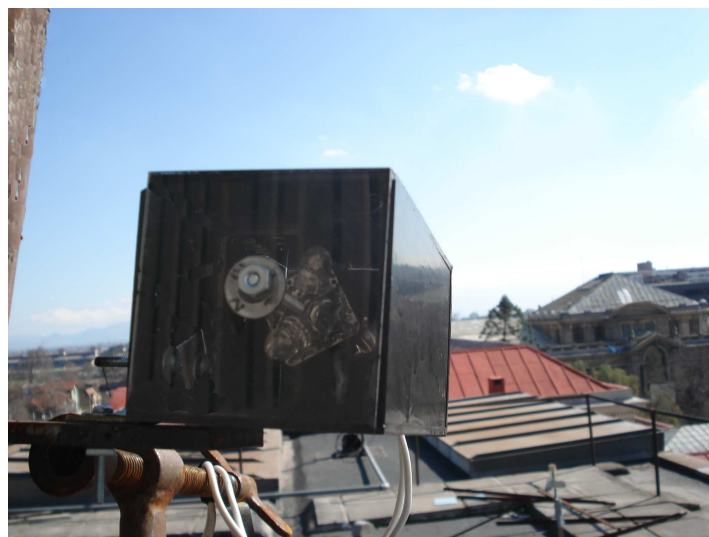
Figura 4.10: Grupo de LED del seguidor en caja oscura de acrílico
