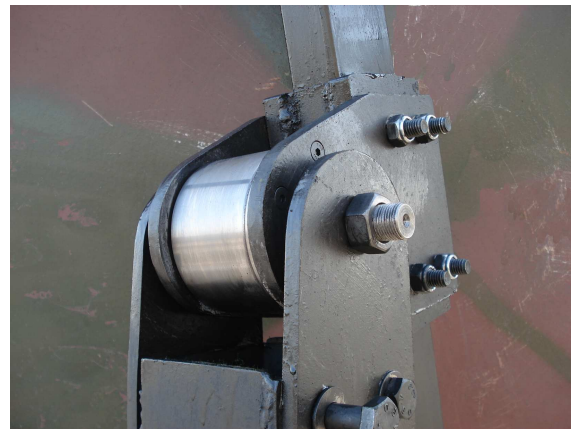
Figura 4.3: Eje de giro en elevación
