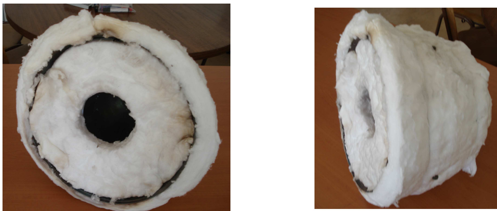
Figura 4.15: Receptor construido para el colector
