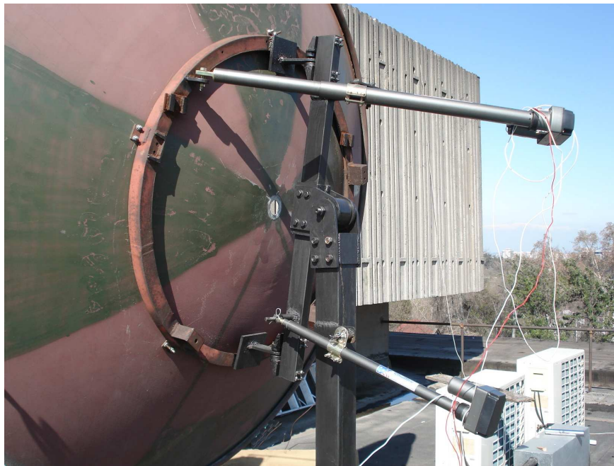
Figura 4.5: Actuadores lineales colocados en la montura
