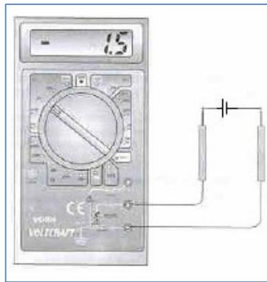
Figura 7: Esquema medición Voltaje Continuo
