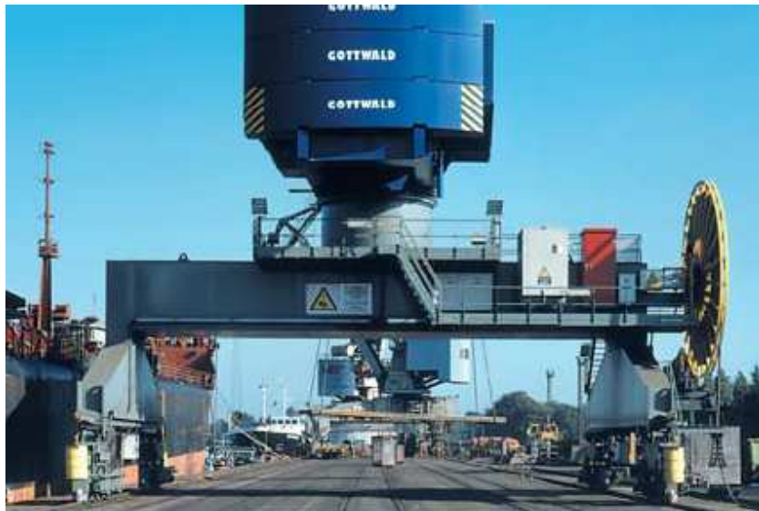
Figura nº15: Sistema de traslación de una grúa móvil.
