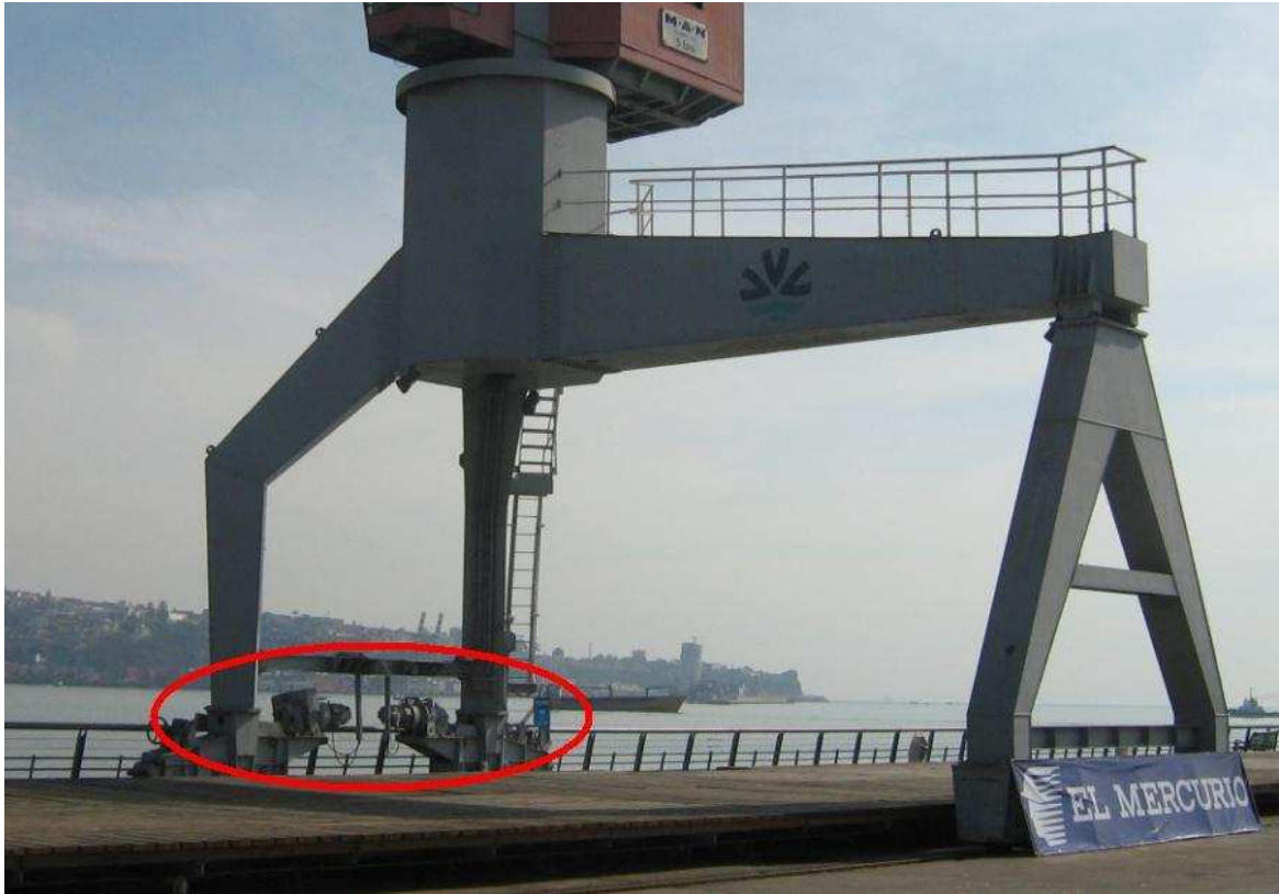
Figura n°22: Disposición de los motores en los apoyos del carro de traslación.
