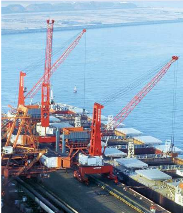
Figura nº 7: Grúa tipo móvil o portal.
