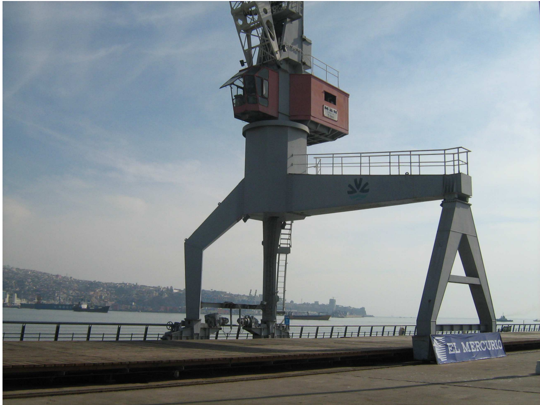
Figura nº19: Grúa soportada en 4 partes, cada una con ruedas sobre rieles.
