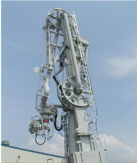
Figura 2.2: Brazo de descarga.
