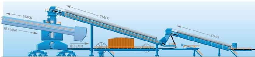
Figura 6.7: Configuración Tripper.
