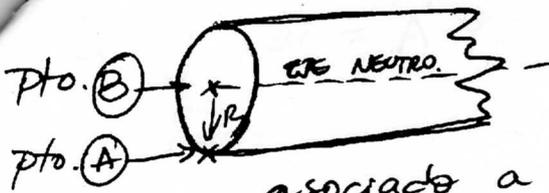
PARA EL ANÁLISIS DE ESFUERZOS NORMALES QUE EN EL PTO. (A), se tiene un esfuerzo combinado de compresión, asociado a la fza.  $N$ , y flexión producto del momento  $M$ . Por otra parte, el pto. (B) ubicado en el eje neutro, sólo está sometido a la fza. de compresión  $N$  (el eje neutro, no observa flexión por definición). Algebráicamente, se tiene que:
