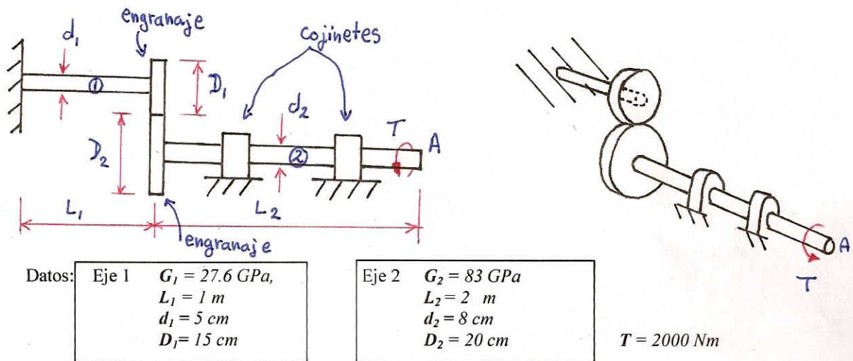
Determine el ángulo de rotación total en el punto A. Determine el valor de los máximos esfuerzos de corte en los ejes 1 y 2.
