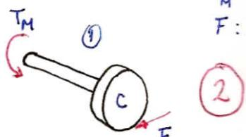
$T_M$ : torque de reacción de pared sobre eje ① $F$ : fuerza interacción engranaje
