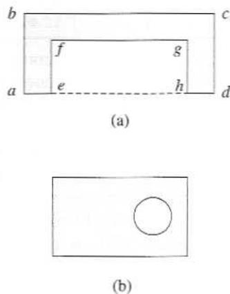
FIGURA 12-7 Áreas compuestas con un recorte y un orificio.
