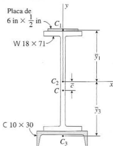
FIGURA 12-8 Ejemplo 12-2. Centroide de un área compuesta.
