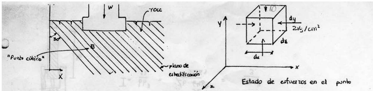
Si se monta una estructura pesada se estima que el estado de esfuerzos en el cimiento de roca es esencialmente bidimensional como se muestra en la figura. Si la roca está estratificada formando los estratos un ángulo de  $30^\circ$  con la vertical. Se pregunta si es admisible el estado de esfuerzos previsto.
