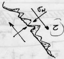
Resistencia a la rotura en el plano de estratificación
