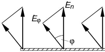
La intensidad de radiación  $I$  de una radiación emitida por un elemento plano es igual en todas las direcciones. En cambio, la capacidad de radiación  $E$  disminuye con el coseno del ángulo  $\varphi$ :
