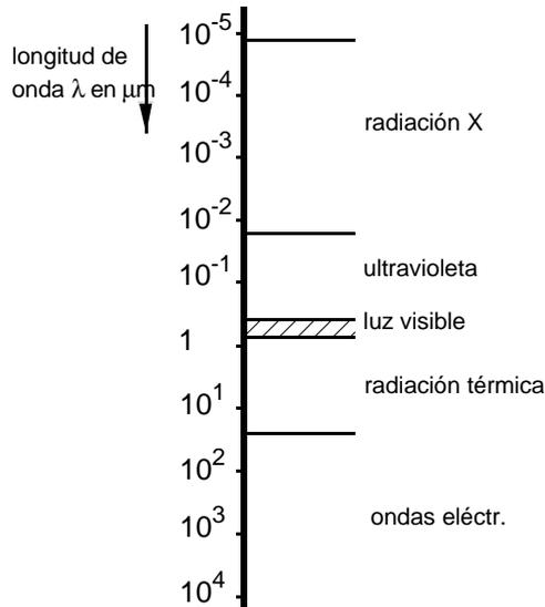
Fig. 4.1 Espectro de frecuencias de radiación electromagnética
