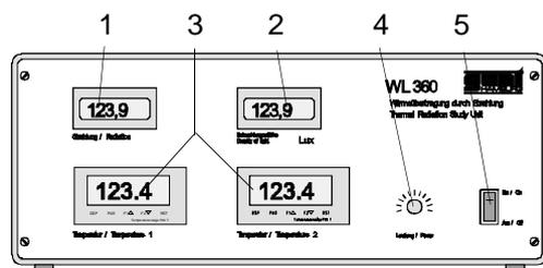
Fig. 2.3 Manejo del amplificador de la medición
