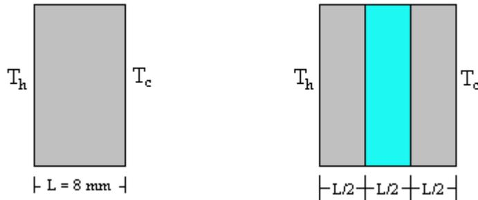
Para el sistema en la figura, se muestran las temperaturas en las paredes (puede extenderse a temperatura de ambiente con convección).
