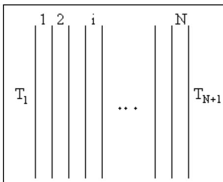
En que las temperaturas de las paredes son  $T_1$  y  $T_{N+1}$ . El flujo de calor que se establece en cada material es constante en estado estacionario.
