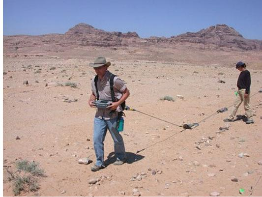
**Figura 29: trabajo en terreno con el ohmmapper**
