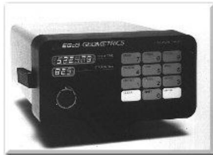
**Figura N°17: panel de control del magnetómetro Geometrics G-856**
