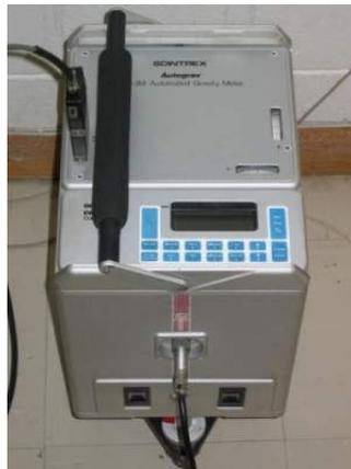
**Figura N°5: Gravímetro Scintrex CG-3M Autograv**
