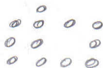
cristal con 1 defecto SchoHky (2D)
