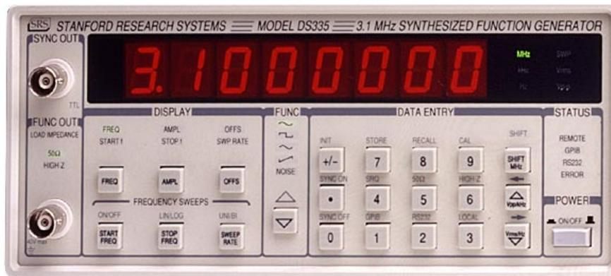
Figura 4: Foto del generador de funciones que muestra en el extremo inferior izquierdo las teclas a usar para el barrido de frecuencias.
