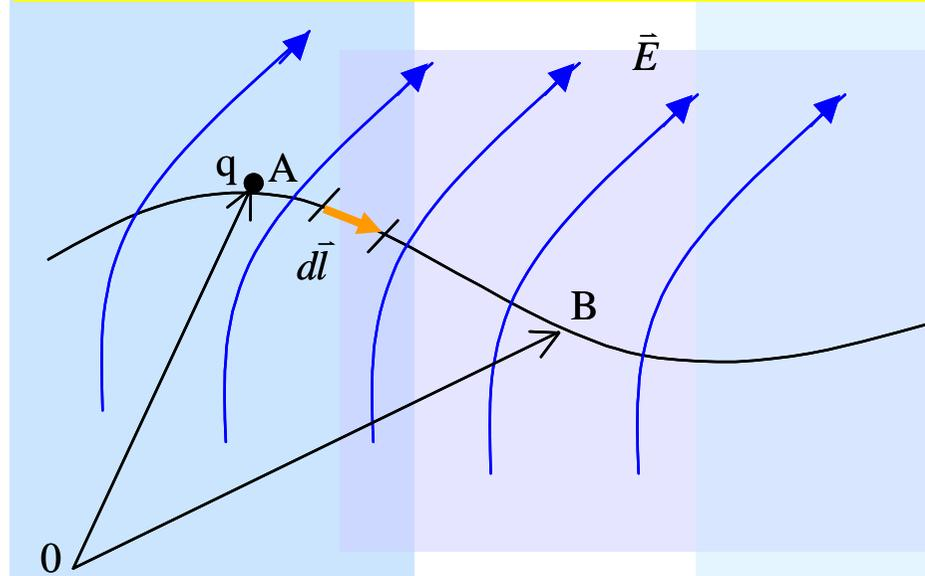
$$V_{AB} = V_A - V_B = \frac{W}{q} = -\int_A^B \vec{E} \cdot d\vec{l}$$
