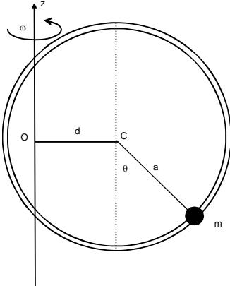
Colocando sistema fijo al aro con origen en C que rota con  $\vec{\omega} = \omega \hat{k}$  constante
