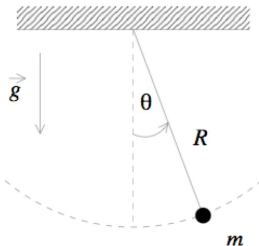
Para encontrar una solución para la posición definida por el ángulo  $\theta(t)$  lo más sencillo es utilizar la ecuación de torque c/r al punto de apoyo del hilo ya que la tensión no realiza torque. La velocidad angular es  $\omega = \dot{\theta}$  y la velocidad tangencial  $v = R\omega$ . El momento angular de la partícula c/r al punto de apoyo del hilo es  $\vec{l} = \vec{r} \times \vec{p}$  cuyo módulo es
