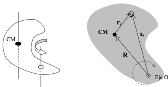
Figura 5: Geometría para Teorema de Ejes Paralelos.
