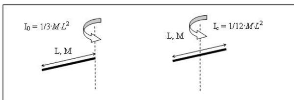
Figura 2: Momento de Inercia de una barra delgada
