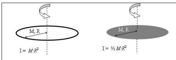
Figura 1: Momento de Inercia de un aro y un disco
