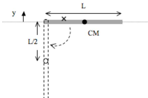
Podemos resolver este problema fácilmente considerando la energía mecánica del sistema  $E = K + U_g$ . Para  $U_g$  tomemos como referencia el nivel donde la barra está horizontal. Como la rotación ocurre en torno a un extremo,  $I_0 = \frac{1}{3}ML^2$ . Suponiendo que la barra es uniforme, su CM está en su centro geométrico. Si la barra parte del reposo se tiene  $E_i = K_i + U_{gi} = 0 + 0$
