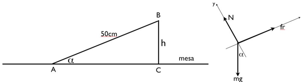
A partir del DCL con aceleración nula obtenemos  $N = mg \cos \alpha$  y  $f_r = mg \sin \alpha$ .
