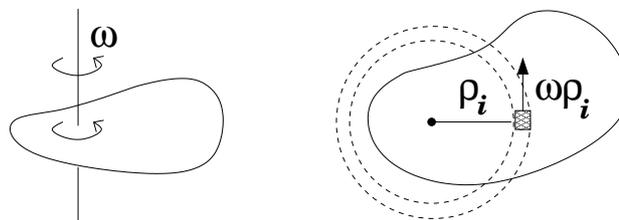
Figura 3: Un cuerpo plano rotando en torno a un eje fijo; a la derecha se ilustra una vista desde arriba.
