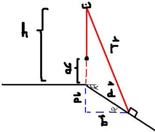
Nos dicen que el carro avanza con velocidad constante  $v_0$ , que el largo total de la cuerda es  $2h$  y que la altura de la polea es  $h$ .
