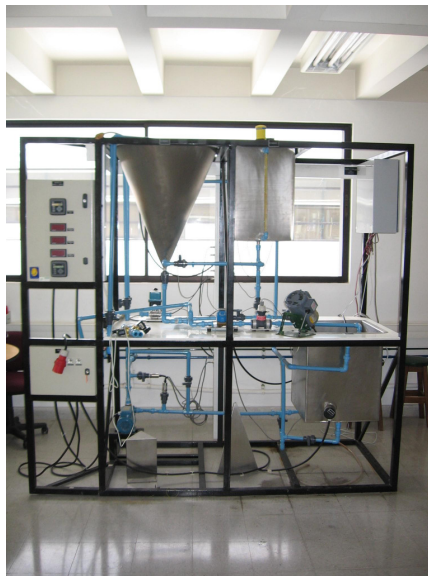
Figura 2: Planta de nivel del Laboratorio de Automática.
