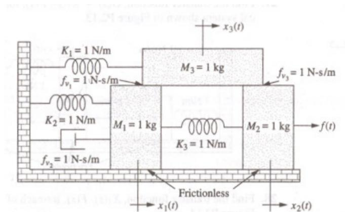
Figure 1: Sistema Mecánico.
