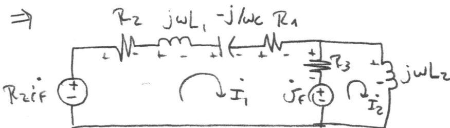
$$\Rightarrow (R_2 + j\omega L_1 - j/\omega c + R_1) \dot{I}_1 + R_3 (\dot{I}_1 - \dot{I}_2) + U_f = R_2 \dot{I}_f$$
