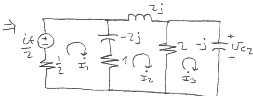
$$Z_L = \frac{V_L}{I_L} = \frac{j\omega L i_L}{i_L} = j\omega L = 2j$$
