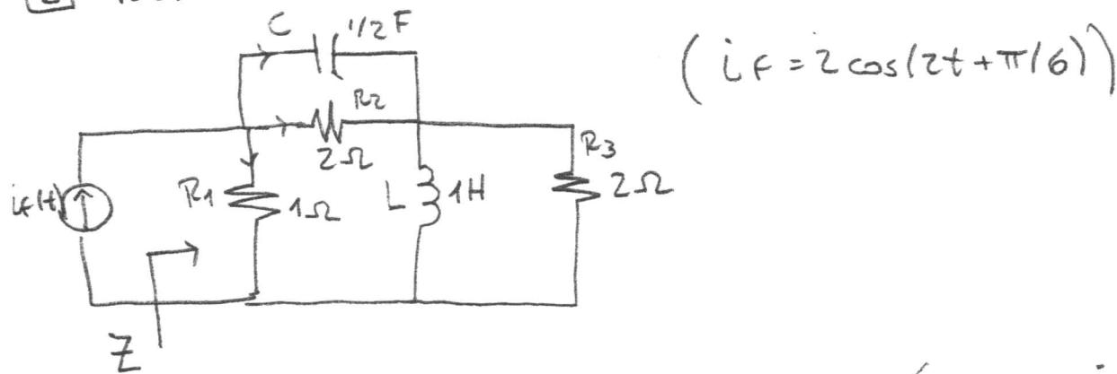
$$\underline{\text{sOL}} \quad \text{a) Pase todo a admittancias. } Y_L = \frac{I_L}{V_L} = \frac{I_L}{j\omega L I_L} = \frac{-j}{\omega L}$$
